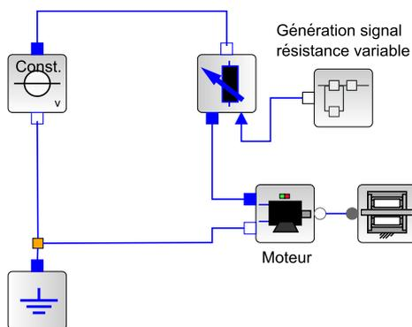
Afin de modéliser le comportement de ce type de système, sur le schéma électrique suivant une résistance est placée en série avec un moteur électrique.
